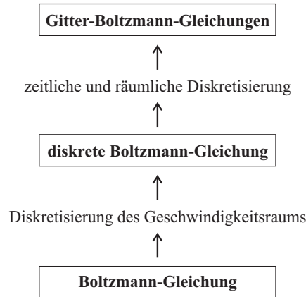
Abbildung 5.1: Zweistufige Diskretisierung der kontinuierlichen Boltzmann-Gleichung. Ergebnis ist die Gitter-Boltzmann-Gleichung.
